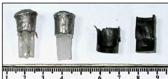
Рис. 2: Общий вид двух свинцовых пуль «Бреннеке» (слева) и двух половинок контейнеров от пуль колпачкового типа (справа)
