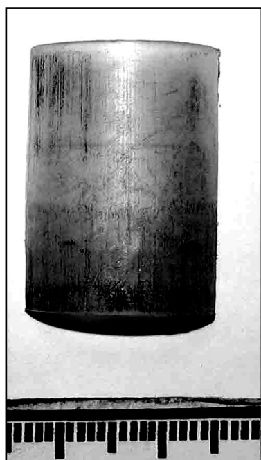
Рис. 8. Следы от канала ствола оружия на половинке контейнера от пули «Полева»
